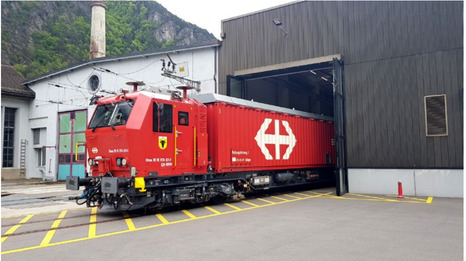
Lösch- und Rettungszug Erstfeld, Modell 14, bei der Fahrt aus dem Erhaltungs- und Interventionszentrum.
